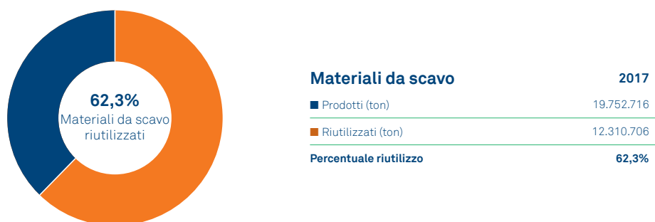
Figura 19: Riutilizzo dei materiali da scavo nell'ambito dei progetti (G4-EN2).
